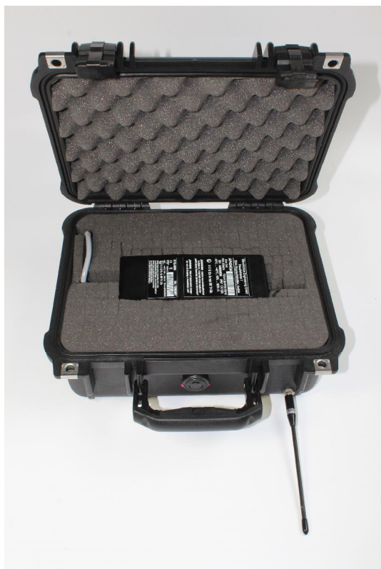
Echtzeit Durchflussdatenlogger mit GPRS Datenübermittlung
